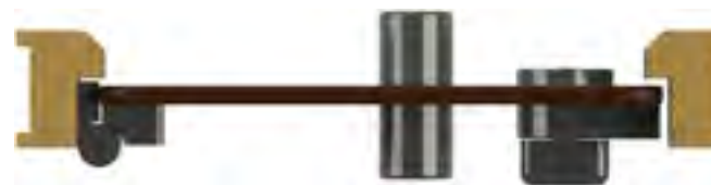
Dørmontering i eksisterende tømmeramme
